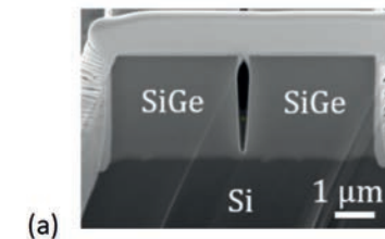
Figure 1: (a) Image de microscopie électronique à balayage montrant le gap de 250 nm entre un résonateur en SiGe/Si et son guide d'accès, aux dimensions de 3.5 x 3.5 \mu\text{m} . (b) Mesures du facteur de qualité Q pour un résonateur en \text{Si}_{0.6}\text{Ge}_{0.4}/\text{Si} avec un gap de 500 nm et pour dimension 3.5 x 5 \mu\text{m} .
